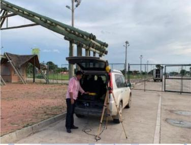
Las bandas que se monitorean para ambientes *no controlados* son 5, que abarcan todos los servicios que utiliza el espectro radioeléctrico desde: 0,3 MHz a 3.000MHz.
