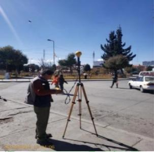
Las bandas que se monitorean para ambientes *no controlados* son 5, que abarcan todos los servicios que utiliza el espectro radioeléctrico desde: 0,3 MHz a 3.000MHz.
